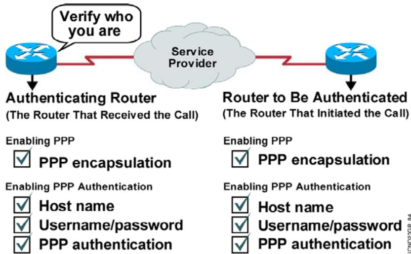
**مروری بر مراحل تنظیم کردن PPP روی یک لینک نقطه به نقطه :**
